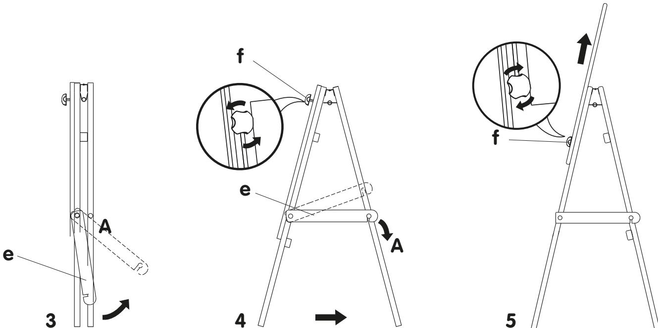
**3** Tourner le bouton rotatif « e » vers le point A selon les flèches ci-dessus et déplier le support.
